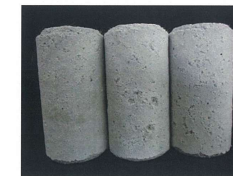
硫酸浸漬後写真 (NJSモルタル)
