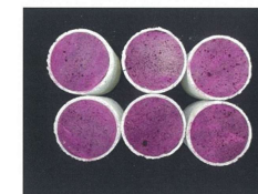
切断写真 (NJSモルタル)
