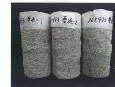
硫酸浸漬後写真 (1:4普通セメントモルタル)
