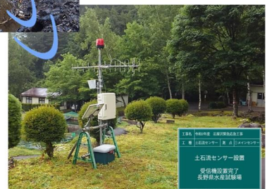
土石流センサー の設置 (日義国有林)
