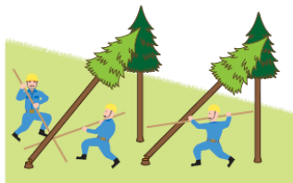
（図2）かかり木の処理
