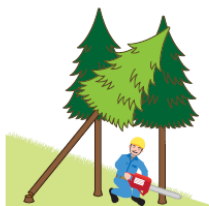
（図3）かかっている立木の伐倒
