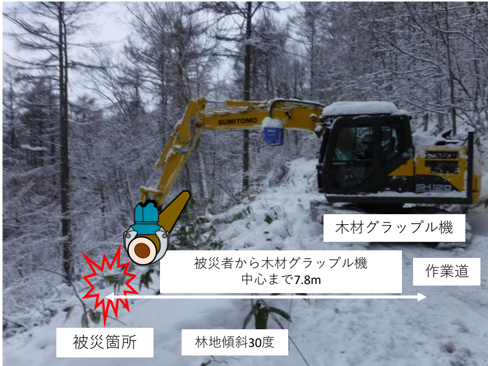
被災箇所の位置関係（側面側から）
